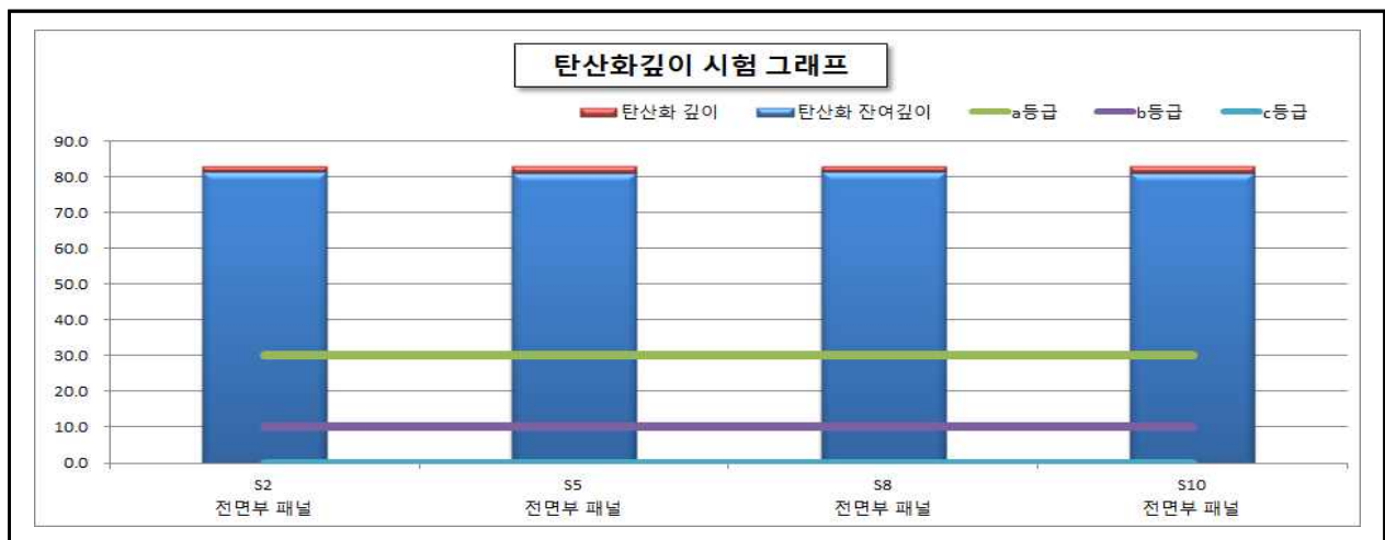
【그림 76.8】 탄산화 깊이 측정결과
